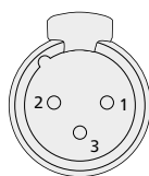
SALIDA DMX Conectores XLR (vista trasera)
